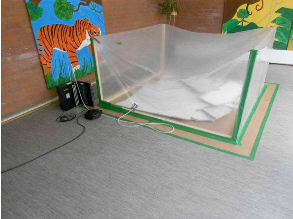
*Bild 8: Emmisionsprüfkörper für Deckenplatten*
